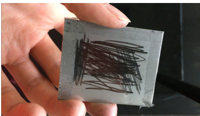
図3 色素増感太陽電池製作② ステンレス版に鉛筆を塗る工程。
