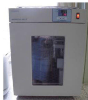
図1 実験に使用した材料 図2 インキュベーター り付け、パンのカビによって埋め尽くされた方眼の個数を比較する。シャーレはパンの乾燥を防ぐためラップに包み、温度 23℃、湿度 80% に保ったインキュベーター内に1週間保存して観察した。
