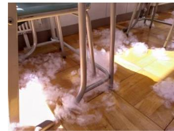
図9 窓を開けると綿が窓際に移動した様子
