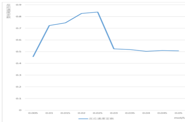
図 5 濃度を変えた時の反応速度定数の変わり方 KI03ver
